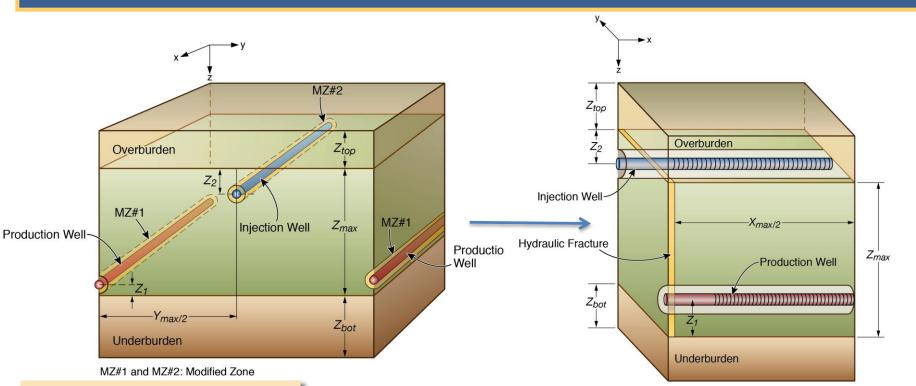
**REFERENCE CASE**  $Z_{max} = 10 \text{ m} (33 \text{ ft})$  $Y_{max}/2 = 10 \text{ m} (33 \text{ ft})$  $Z_1 = 1 \text{ m} (3.3 \text{ m})$  $Z_{top} = Z_{bot} = 0$
